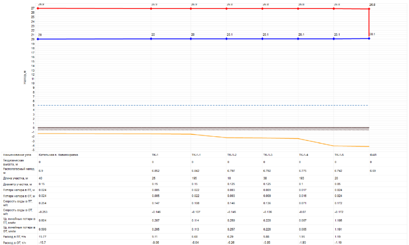
Рисунок 2.6 – Пьезометрический график работы котельной п. Новопокровка
